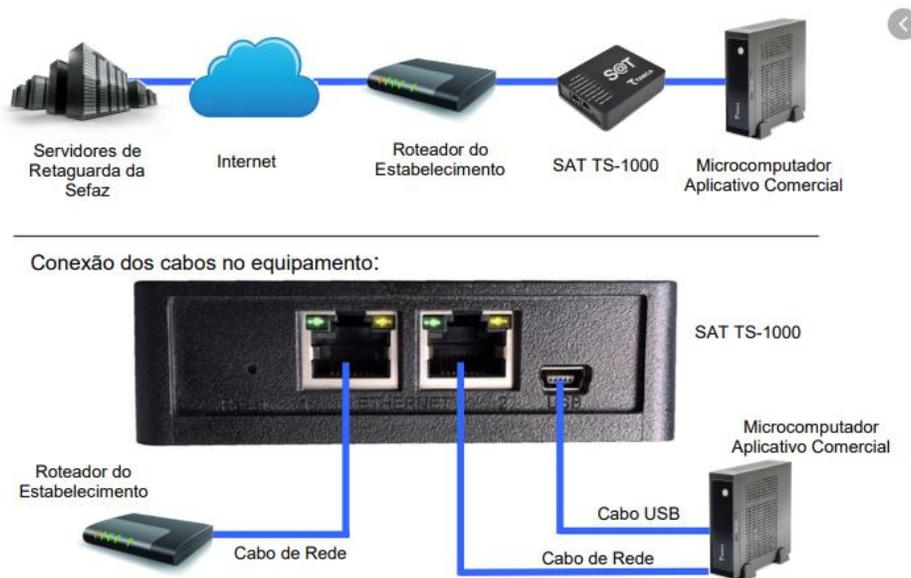
Após ligar os cabos corretamente no SAT, depois de alguns segundos as três primeiras luzes do equipamento ficaram acesas constantemente mostrando que o SAT está ligado, em operação e conectado a rede.
